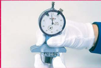
중앙부가 뚫린 측정물의 들어간부분의 깊이를 측정하고 있습니다. 사진은 2.03mm를 가르키고 있습니다.
