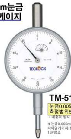
TM-5106 눈금폭이 크고 판독이쉬운 타입 눈금0.01mm 측정범위5mm • 내충격 방지
