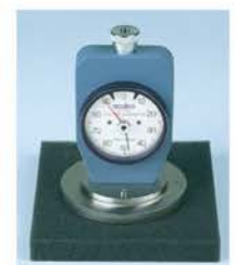
GS-744G를 스펀지시트에 두고, 경도를 측정하고 있습니다. 발포정도의 분산성도 판정할 수 있습니다.
