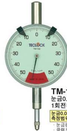
TM-1211 1회전미만의 광범위 모델 눈금 0.001mm 측정범위 0.2mm · 클램프 부속
