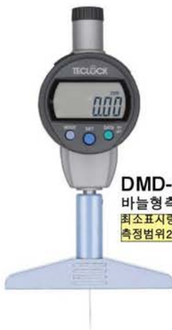
DMD-215J 대형베이스와 연결로드 최소표시량0.01mm 측정범위220mm 지시범위12mm · 연결로드5개 부속
