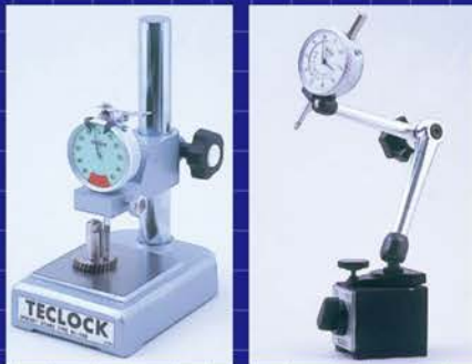
다이얼게이지를 부착한 스템에 측정물을 두고 측정하거나(사진좌), 마그네틱베이스에 붙여 측 정물을 측정하는 것도 가능합니다.(사진우)
