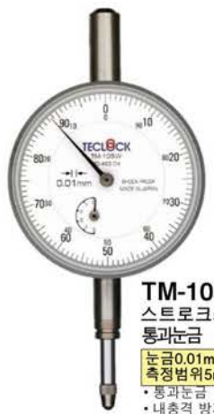
TM-105 실린더게이지에 적합한 나눔 눈금 눈금0.01mm 측정범위5mm • 내충격 방지 • 좌우 나눔 눈금 • 평면 백커버
