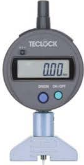
DMD-252S2 프린트기판 측정용 요철양면의 측정가능 최소표시량 0.01mm 측정범위오목5mm볼록4mm
