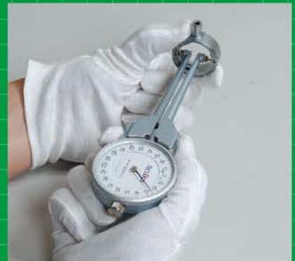
소형금속부품의 내경을 측정하고 있습니다. 사진은 설정한 기준치수로부터 0.25mm, 마이너스측으로 흔들리는것을 나타내고 있습니다.
