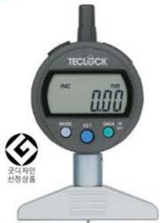
DMD-210J 바늘형측정자타입 최소표시량0.01mm 측정범위12mm
