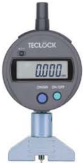
DMD-2520S2 프린트 기판 측정용 요철양면의 측정이 가능 최소표시량0.001mm 측정범위오목5mm볼록4mm
