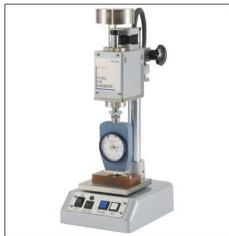
측정자의 개인차를 제거하기 위해, 듀로미터를 스탠드에 부착해서 경도측정을 하는 것도 규격에 명기되어 있습니다.
