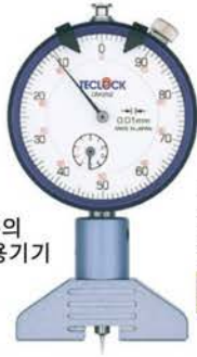
DM-252 요철양면의 측정가능합니다 눈금0.01mm 측정범위오목5mm볼록4mm
