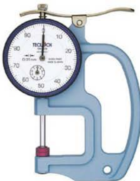
SM-528 두께20mm까지의 측정물이 측정할수 있는 소형 시그네스 눈금0.01mm 측정범위20mm · 측정자, 앤빌=세라믹제
