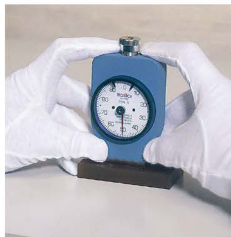
손으로 누르는 것에 의한 경도측정은, 듀로미터를 바로 위에서부터 측정물에 꼭 눌러 가압면을 밀착시켜 값을 읽습니다.
