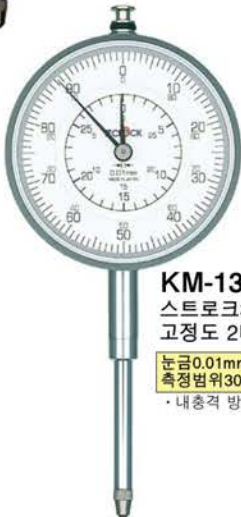
KM-131 스트로크30mm의 표준타입 눈금0.01mm 측정범위30mm · 내충격 방지
