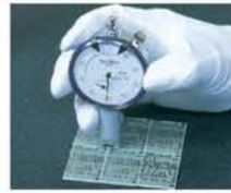
DM-251을 이용한 프린터기판 홈 깊이가 측정
