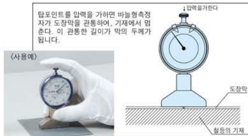
도막방수재의 두께 측정 (압력을 가하여 측정합니다)
