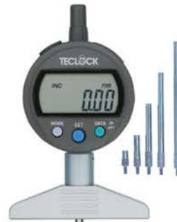
DMD-214J 표준베이스와 연결로드 최소표시량0.01mm 측정범위220mm 지시범위12mm · 연결로드5개 부속
