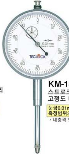
KM-132D 스트로크30mm의 2바늘표준 타입 눈금0.01mm 측정범위30mm · 내충격 방지
