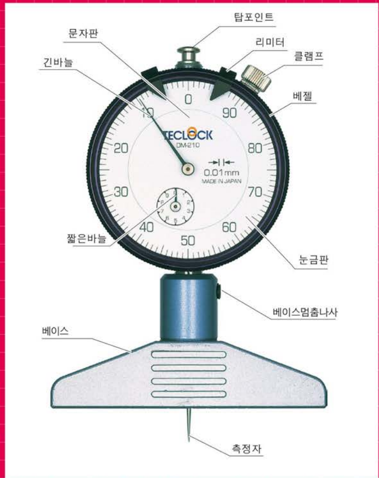
중앙부가 뚫린 측정물의 들어간부분의 깊이를 측정하고 있습니다. 사진은 2.03mm를 가르키고 있습니다.
